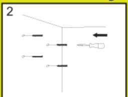
۳– پنل توکار روی پیچها بصورت آویز نصب شود.
