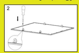
۲ – قلاب آویز مطابق شکل با پیچ های موجود، در سقف نصب شود.
